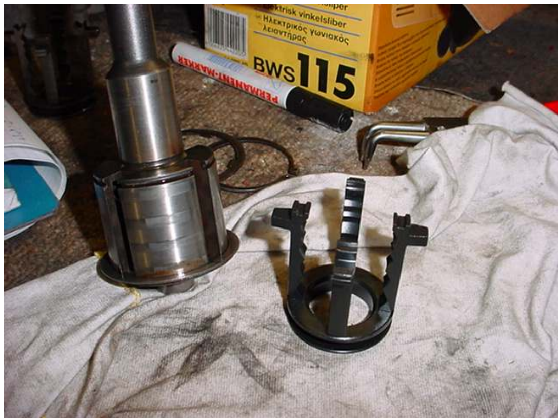
Antriebswelle + neue Schaltklaue (eckige Variante)
