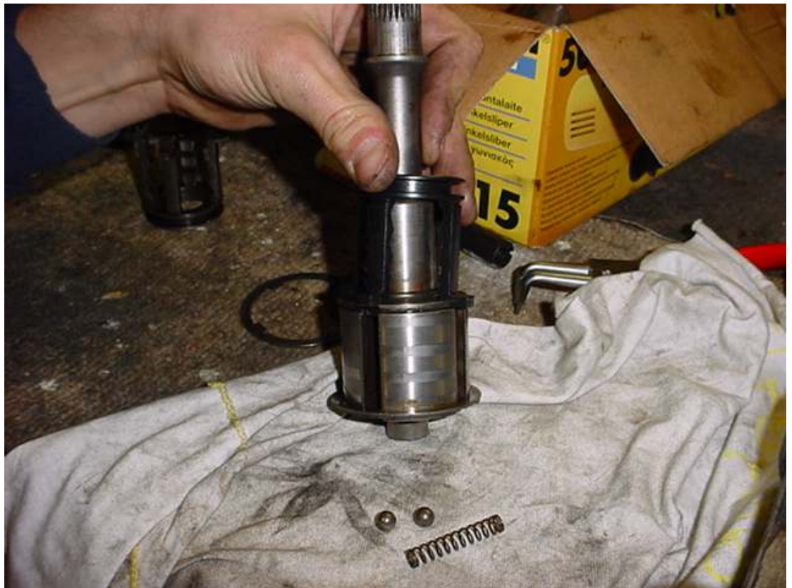
Einfahren der Schaltklaue in die Antriebswelle + Verkanten
